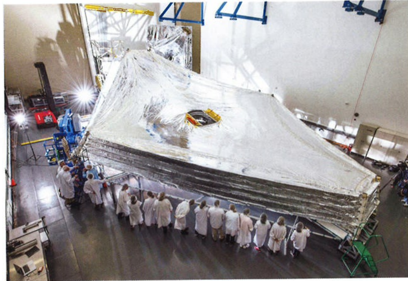
Figuur 4 Een testversie van het JWST-zonnescild met vijf lagen folie, opgebouwd in een cleanroom bij Northrop Grumman in Redondo Beach, California. Foto: NASA/Chris Gunn.
