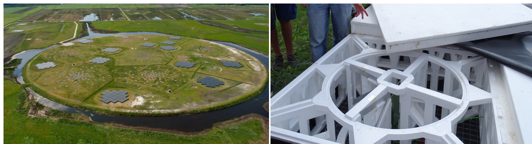
Figure 7.22: Links : LOFARs zogeheten superterp in Exloo, Drenthe. De grijze tegels zijn de HBA antennes. De bruingrijze vlakken zijn de platformen waarop de LBA antennes staan. Rechts : een close-up van een HBA tegel waar de antennes te zien zijn, omhult door piepschuim. Bron: LOFAR / ASTRON (links); B. Wolba (rechts).
